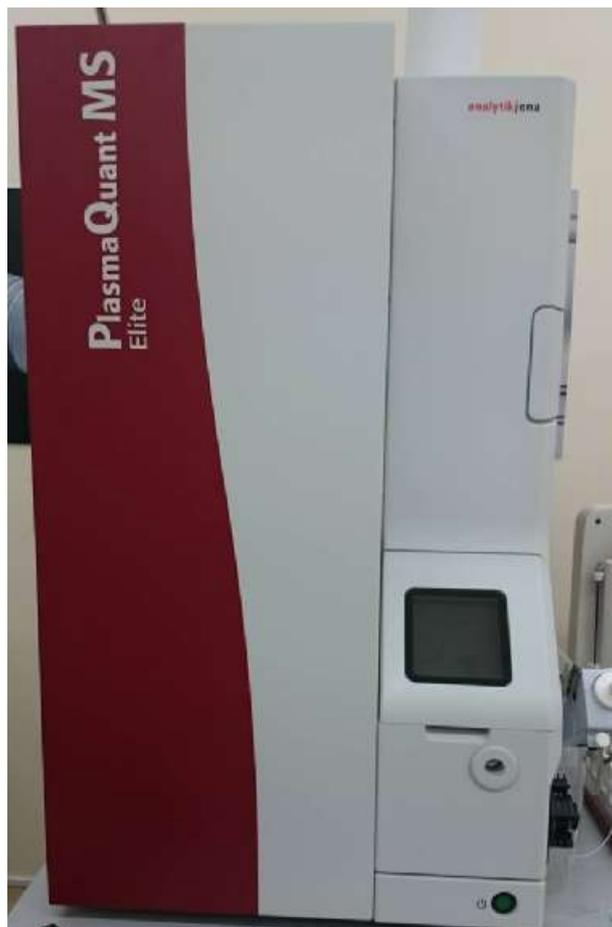
Рисунок 1 – Внешний вид масс-спектрометров с индуктивно связанной плазмой.
